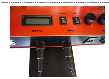
7. Detailbild der Anschlüsse [Hinweis: Wenn die Kabel der Einmannbedienung angeschlossen sind, ist der Joystick am Steuerkasten inaktiv] / Detail picture of the connections [note: if the cables of the one man operation are attached, the joystick is inactive at control panel]
